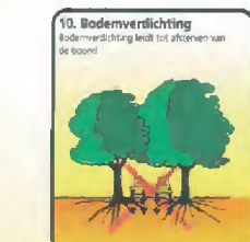
Bouwplaats/Bouwverkeer afbeelding 4-5 Binnen de kroonprojectie mogen geen bouw- en directie lijnen staan. Tijdelijke bouwweegen binnen de kroonprojectie zijn uitsluitend toegestaan indien deze zijn voorgeschreven (bestek) in overleg met de boombeheerder en de daarop volgende toestemming van de directie. Gebruik van rijplaten (beton, staal, hout of kunststof) en/of andere voorzieningen zijn dan noodzakelijk.
